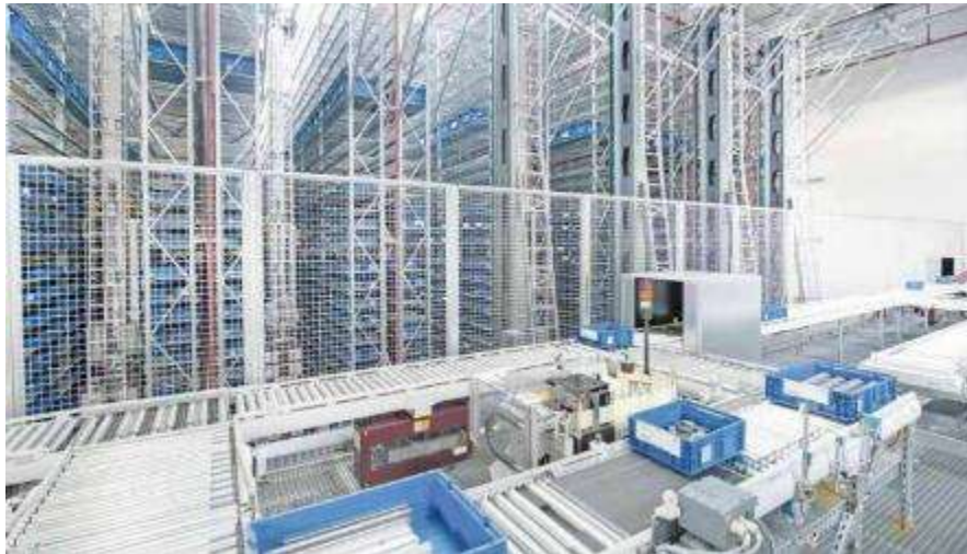
Slika 12: Avtomatizirani skladiščni sistem "miniload" pri podjetju Brose
