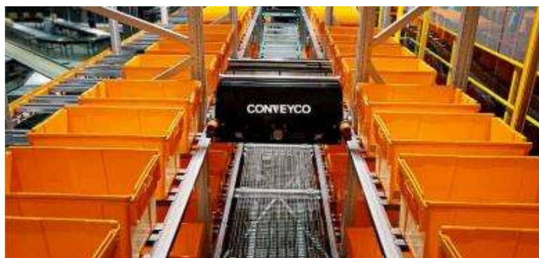
Slika 11: Primer taksijev (angl. »shuttle«)avtomatiziranega sistema za shranjevanje in iskanje
