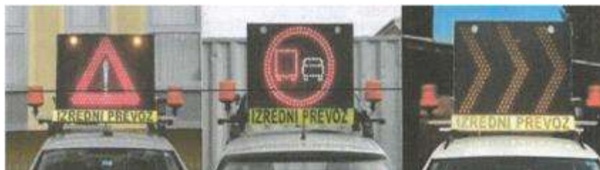
Slika 6: Svetlobna tabla zahtevnega spremljevalnega vozila
