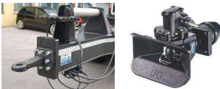
Slika 17: Vlečno uho (levo) in vlečna sklopka (desno)
