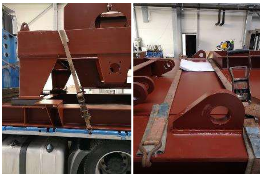
Slika 28: Pritrjevanje tovara za izredni prevoz
