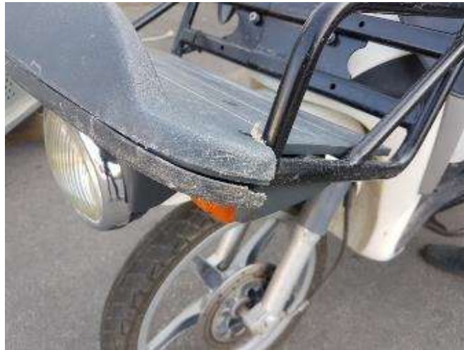
Slika 11: Poškodba sprednjega dela dvokolesa
