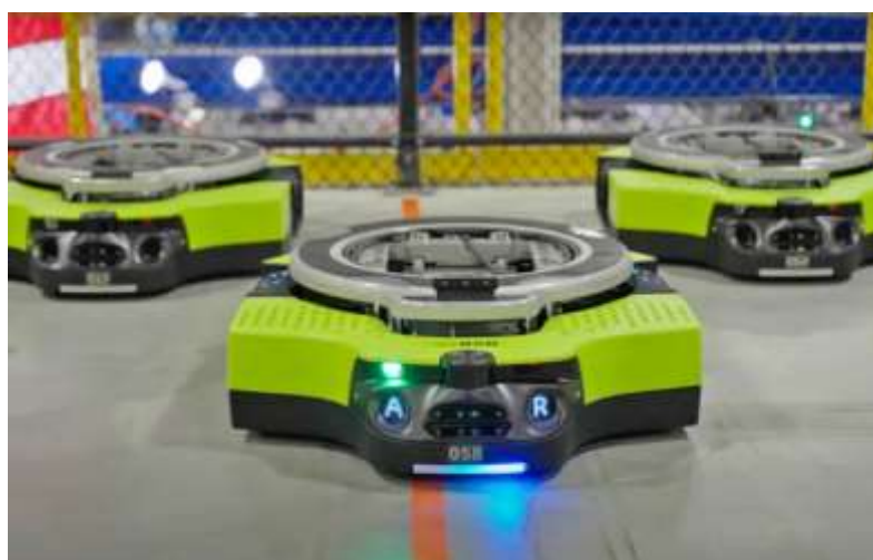
Slika 3: Amazonov robot za premikanje vozičkov Proteus
