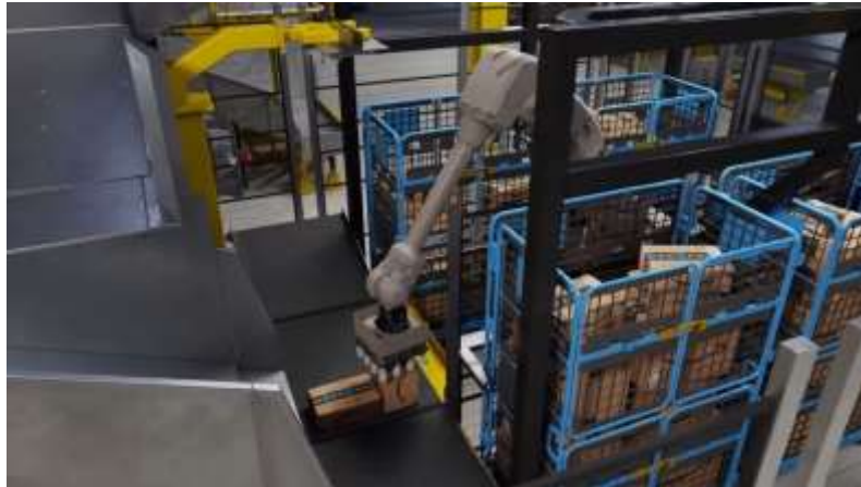
Slika 4: Amazonov robot za natovarjanje Cardinal
