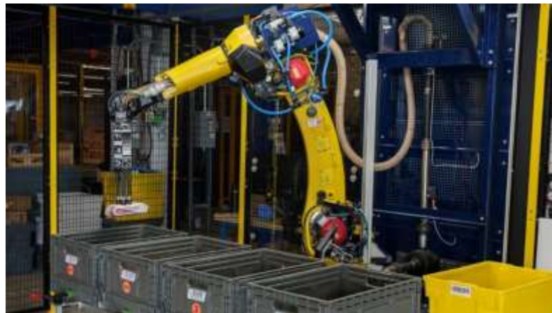
Slika 5: Amazonov robot za obdelavo/sortiranje naročil Sparrow
